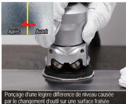
Ponçage d'une légère différence de niveau causée par le changement d'outil sur une surface fraisée
