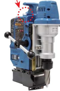
\*Après avoir activé l'interrupteur de l'aimant, le voyant clignote 3 fois de la couleur correspondant au niveau de la batterie. Lorsque le voyant devient vert, l'outil est prêt à l'emploi. Si le voyant clignote 3 fois ou de façon continue en rouge, remplacez la batterie par une batterie pleinement chargée.
