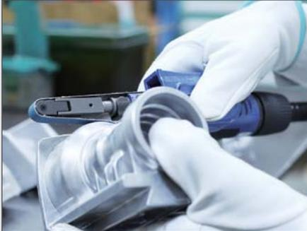
Finition détaillée de matériau en aluminium
