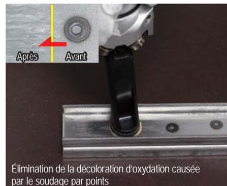
Élimination de la décoloration d'oxydation causée par le soudage par points
