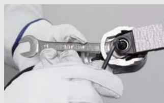
Le remplacement du plateau peut facilement être effectué à l'aide de la clé de 10 et de la clé hexagonale de 4 mm incluses. Dans le cas d'un plateau rond de 2", seule la clé de 10 est utilisée. Utiliser un plateau approprié à la zone de travail ou à la zone à poncer.
