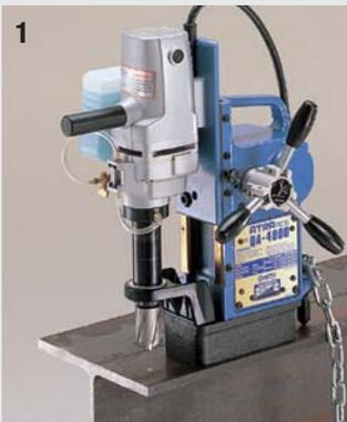
1 Aligner la tige de guidage avec la marque de poinçon du trou à percer. Attacher la machine à la poutre à l'aide de la chaîne de sécurité appropriée et engagez l'aimant. Abaissez le foret depuis l'emplacement de l'interrupteur de fin de course supérieur jusqu'au point de contact de la tige de guidage avec le matériau et enclenchez le moteur.
