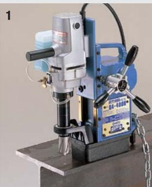
1 Richten Sie den Führungszapfen am Körnerpunkt der zu bohrenden Bohrung aus. Befestigen Sie die Maschine mit einer geeigneten Sicherheitskette am Träger und schalten Sie den Magneten ein. Senken Sie den Bohrer von der oberen Endschalterposition bis zur Kontaktstelle des Führungszapfens ab und schalten Sie den Motor ein.
