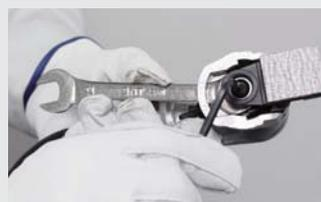
Der Pad-Wechsel kann problemlos mit dem beiliegenden Schraubenschlüssel 10 und dem 4 mm-Innensechskantschlüssel durchgeführt werden. Beim 2°-Rundpad wird nur der Schraubenschlüssel 10 verwendet. Verwenden Sie je nach Arbeitsbereich oder zu schmirgelnder Fläche ein geeignetes Pad.
