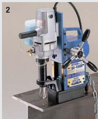
2 Schalten Sie den autom. Vorschub ein, indem Sie die Griffe in Richtung des Gehäuses drücken, und der Motor beginnt automatisch mit dem Vorschub.
