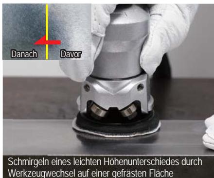
Schmirgeln eines leichten Höhenunterschiedes durch Werkzeugwechsel auf einer gefrästen Fläche
