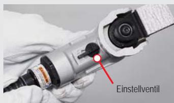
Drehen Sie das Einstellventil, um die Werkzeuggeschwindigkeit zu begrenzen. Stellen Sie die Geschwindigkeit entsprechend dem Werkstückmaterial, der Körnung des Schleifpapiers und der gewünschten Oberflächengüte ein.
