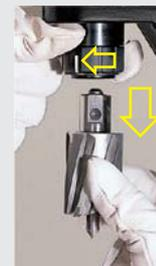
Entfernen des Bohrers
