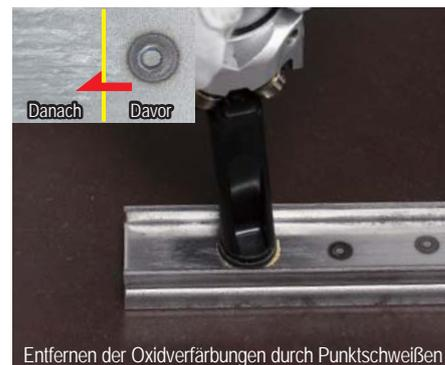
Entfernen der Oxidverfärbungen durch Punktschweißen
