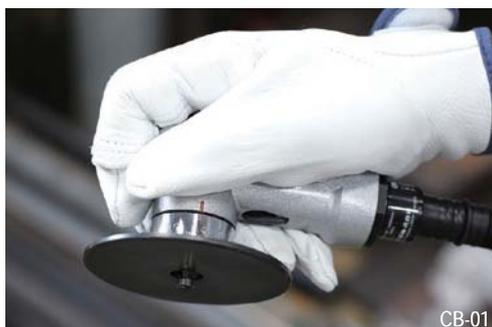
TB09140 Führungsplatte-78 für stabileren Betrieb
