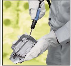
Bestens geeignet zum Entraten von Aluminiumdruckgussprodukten und Maschinenteilen. Die schlanke, leichte und äußerst vibrationsarme Bauweise erlaubt dem Anwender ein ermüdungsfreies Arbeiten über einen langen Zeitraum.
